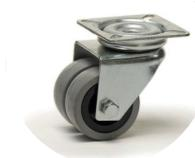
**Série SOMMIER** : Roulette pour literie. Roues jumelées caoutchouc gris non tâchant. Moyeu lisse. Axe riveté. Chape en acier. Pivotement sur deux couronnes de billes.
